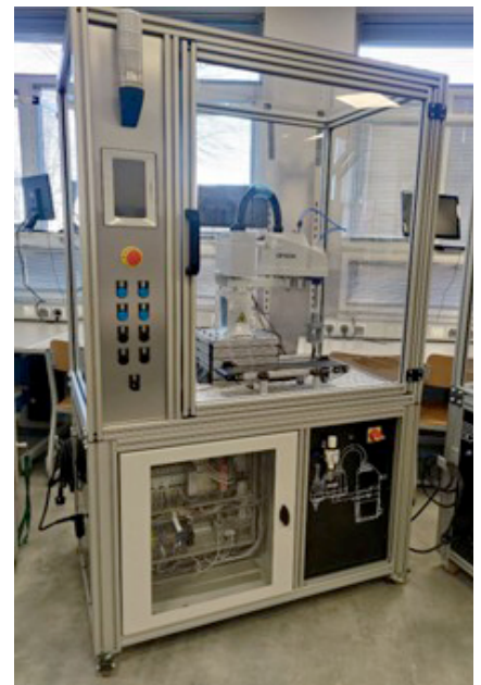
Przykładowy wygląd stanowiska z robotem EPSON T3
